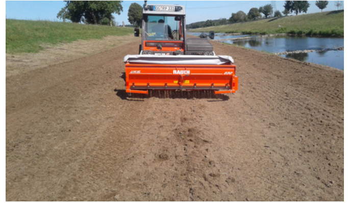
Aussaat mit einem Universalkastenstreuer als Sämaschine
