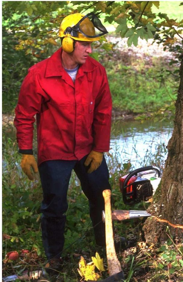
Abb. 115: Mit dem Keil die Fallrichtung unterstützen. Baum umkeilen, nicht umsägen (Quelle: Ewert)
